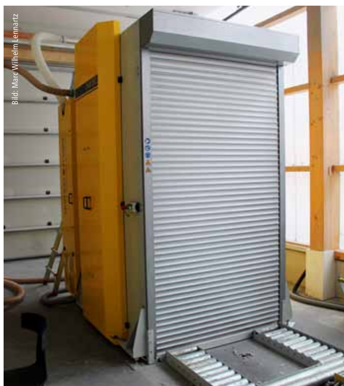
Die Beschickung der Einblaseinheit mit einer Fördermenge von max. 800 kg/h bei einem max. Dämmvolumen von 14 m 3 /h erfolgt über zwei Bunker, die jeweils 2 Big Pack an Dämmmaterial bevorraten.
