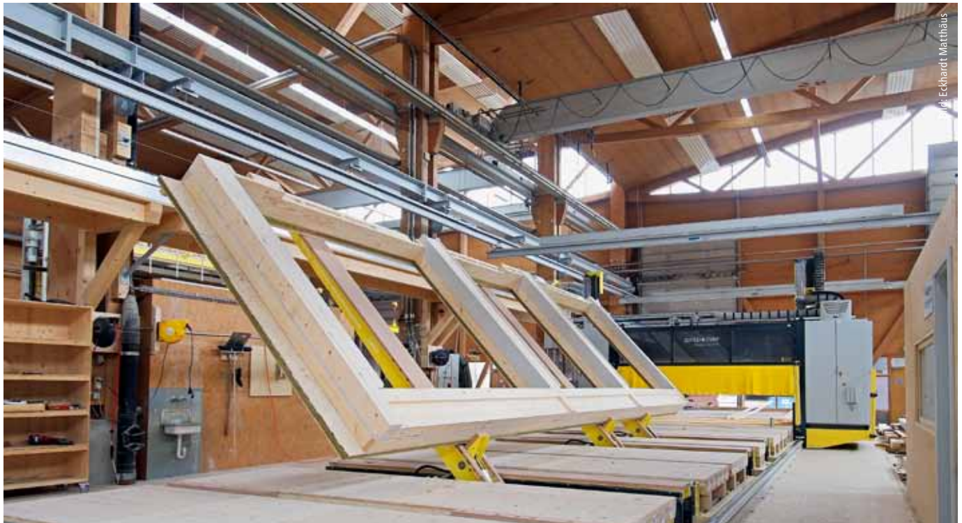
Der Arbeitstisch aus Massivholz bietet neben pneumatischen Förderrollen auch über hydraulisch betriebene, vollautomatische Elementwendeinheiten, ebensolche eine Querfördereinheit, mit der die Bauteile in den Hallenbereich übergeben werden.
