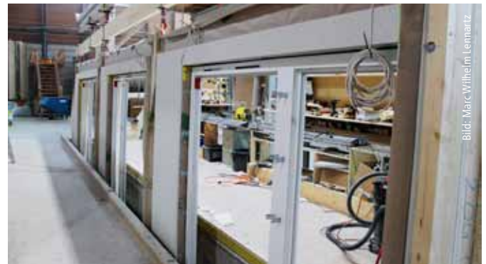
Eine werkseigene Fensterabteilung ist systemimmanenter Bestandteil der Vorfertigung. Zur Wahl stehen Rahmen aus Holz, Aluminium und Kunststoff, die standardmäßig mit einer 3-Scheiben-Isolierverglasung ausgestattet sind und erfüllen die Vorgaben des Schall- und bei Bedarf auch die des Einbruchschutzes.
