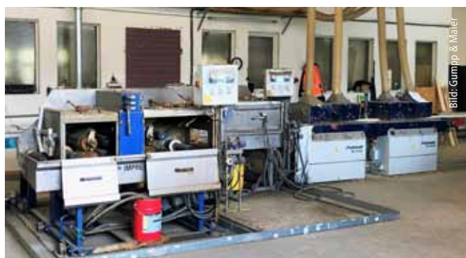
Das Binswanger Werk verfügt über einen eigenen, sogenannten „Impregmaten“, mit dem im Vakuumverfahren kammergetrocknete und gehobelte Bretter beschichtet werden.
