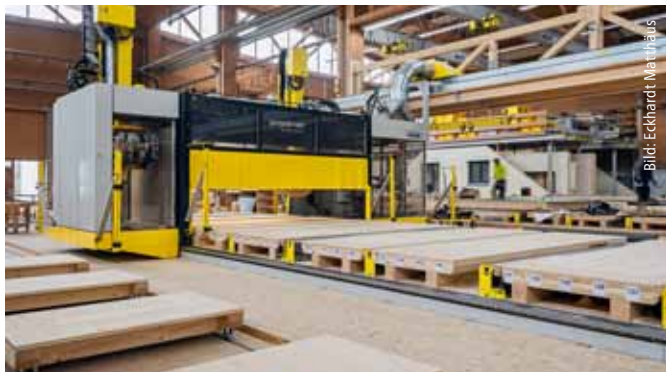
Die zweite Fertigungslinie stammt vom Schweizer Hersteller Technowood. Damit können Bauteile mit einem Höchstgewicht von 5 t und einer maximalen Höhe von 3,85 m angefertigt werden. In den kommenden Jahren lässt sich damit das umgesetzte Bauvolumen sukzessive verdoppeln.
