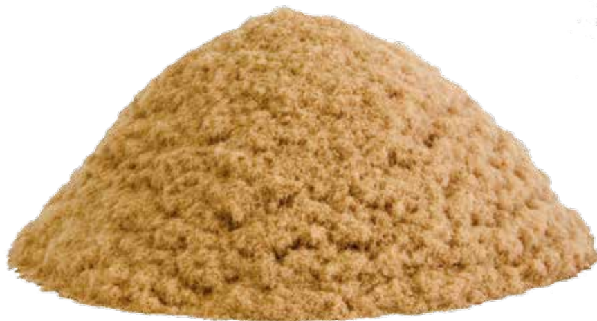
Alternativ gibt es Holzfaserdämmung auch als Flocken zum Einblasen. Das ist vor allem bei der Dämmung von nicht-rechteckigen Hohlräumen sinnvoll.
