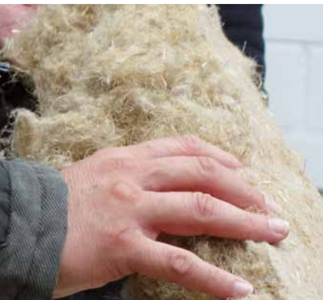
Ebenfalls aus nachwachsenden Rohstoffen, aktuell zwar noch ein Nischenprodukt, aber im Kommen: Dämmmatten aus Hanffasern.
