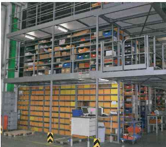
Im Kleinteilelager mit dreigeschossiger Lagerbühne, drei Lagerliften und einem Paternoster warten 5.000 verschiedene Artikel auf den Transport.
