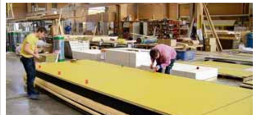
Die Holzrahmenelemente für die neue Verkleidung der Peter-Schweizer-Schule in Gundelfingen wurden von Gump & Maier in Binswangen gefertigt. Foto: pm
